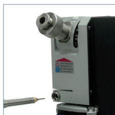
Präzise Längenjustierung der Elektrode.
